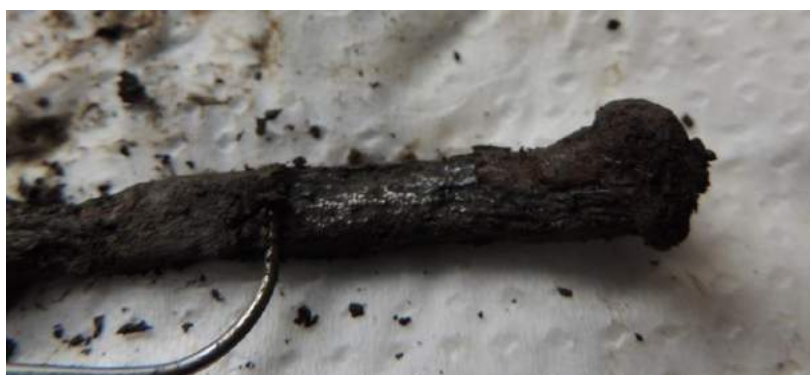
Figura 8: Visualização do suporte metálico com o início da limpeza mecânica. Fonte: Isabel Halfen Torino
