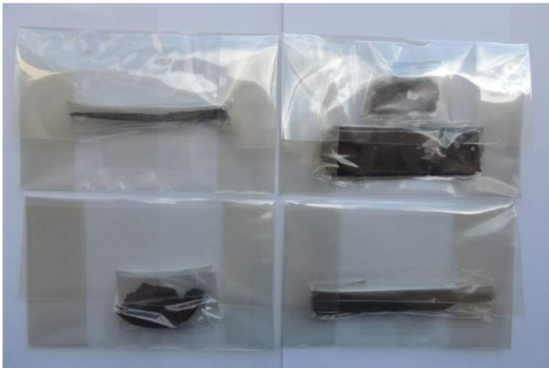
Figura 41- Embalagem das peças metálicas em filme poliéster. Fonte: Isabel Halfen Torino
