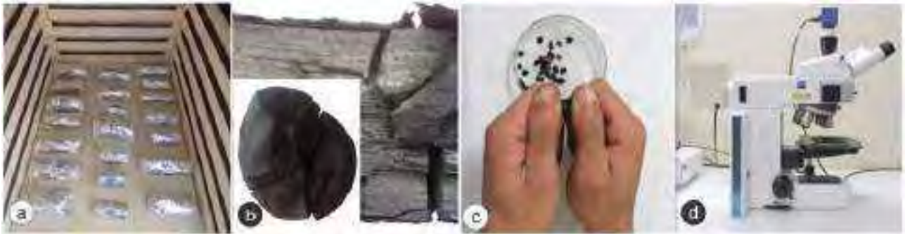
Figura 2: (a) Amostras de lenho embaladas em folha de alumínio com marcações em baixo relevo e caneta indelével, organizadas dentro do forno mufla para a carbonização; (b) aparência dos carvões obtidos após a queima com destaque para as rachaduras (foto maior, plano longitudinal; foto menor, plano transversal); (c) quebra manual dos carvões; (d) microscópio ótico de luz refletida com campo claro e campo escuro utilizado para as descrições.
