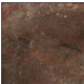
Figura 9: Presença de manganês na superfície da peça (pontos negros). Foto: Agesilau Almada, 2012.
