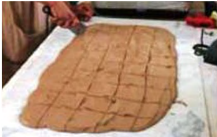
Figura 01: Argila artificial a base de cera de abelha e gesso desenvolvida pelo MAE/UFBA.
