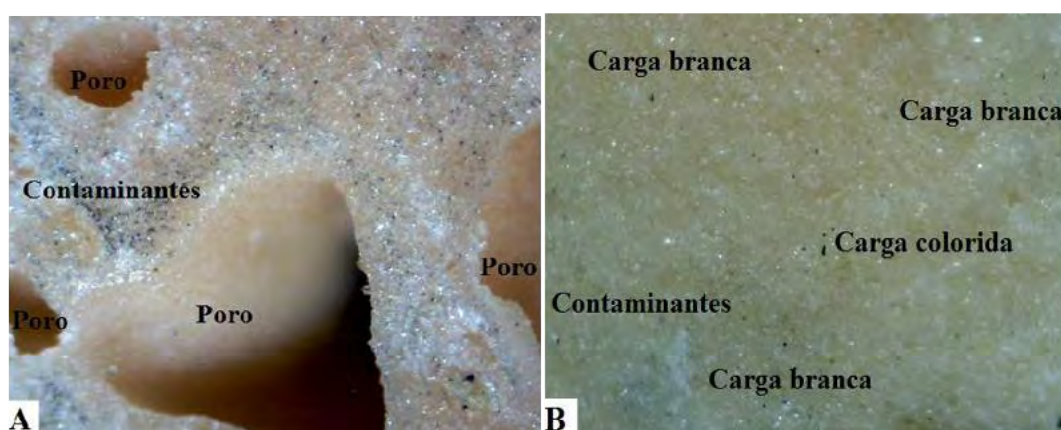
Figura 05: Exame por MO, aumento X400. A) Fotomicrografia da amostra F2C (não processada) – corte longitudinal, face inferior. B) Fotomicrografia da amostra de F2M (processada) – corte longitudinal, face inferior.
