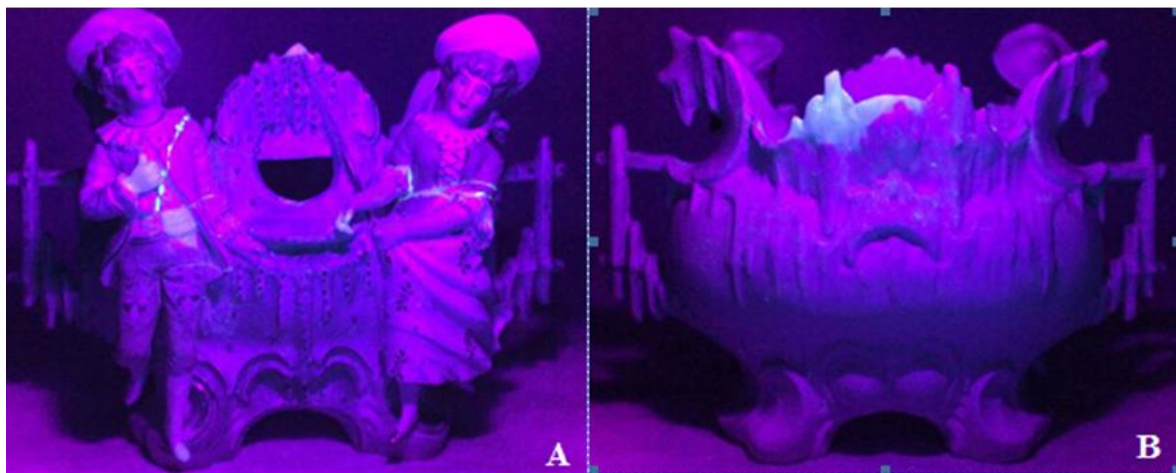
Figura 09: Diferença entre a fluorescência do corpo cerâmico objeto original e dos aditamentos polivinílicos após 15 dias: A) Face frontal da porcelana restaurada; B) Face traseira da porcelana decorada. Fotos: Autora, 2013.
