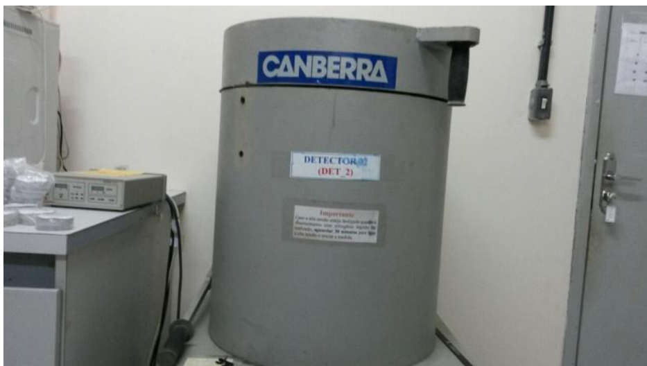
Figura 07: Detector gamma do Departamento de Energia Nuclear – UFPE. 2016. Fonte: Acervo pessoal, 2016
