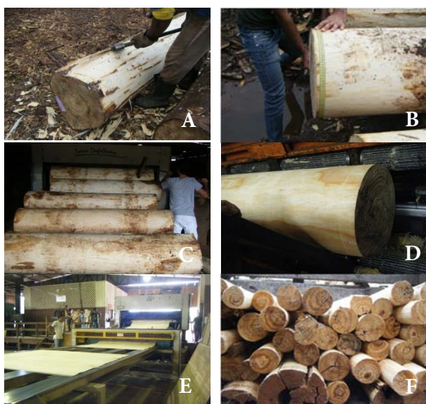
Figura 1. Etapas do processo de laminação: (A) Descascamento de toras; (B) Determinação do diâmetro sem casca; (C) Toras posicionadas na entrada do torno desfolhador; (D) Tora arredondada; (E) lâminas desenroladas sendo guilhotinadas na saída do torno; (F) Rolos resto resultantes do processo de laminação.
