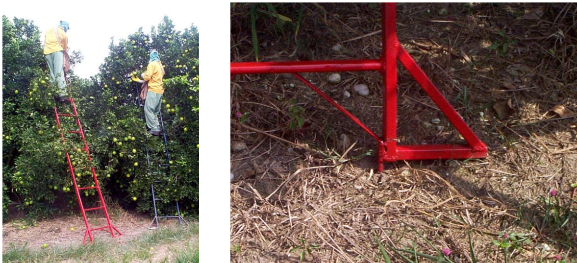
Figura 4 - Escadas modificadas e detalhes da base das mesmas
