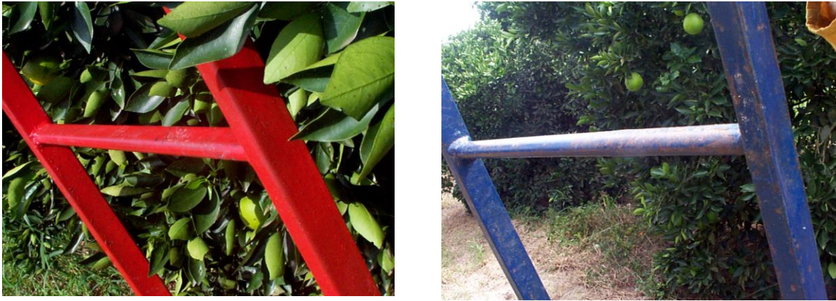
Figura 2 - Degraus com perfil arredondado
