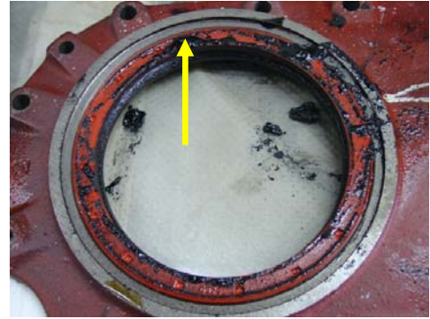
Figura 5 - Obstrução do pescador de óleo do cárter e desgaste do retentor
