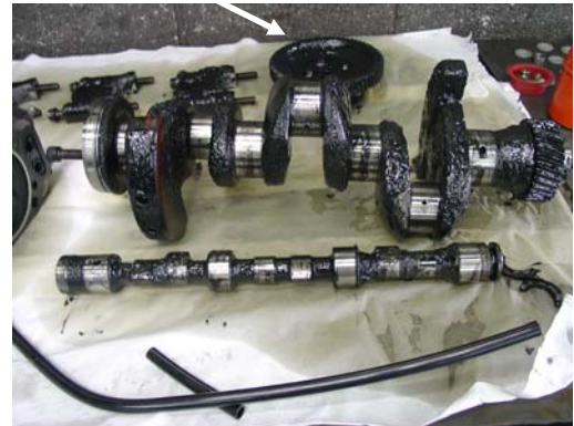
Figura 5 - Obstrução do pescador de óleo do cárter e desgaste do retentor
