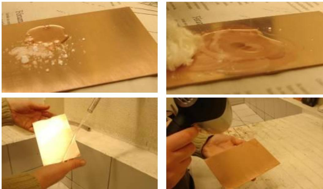
Fig. 10 (a,b,c,d): Iniciamos o processo desoxidando e desengordurando a placa de cobre
