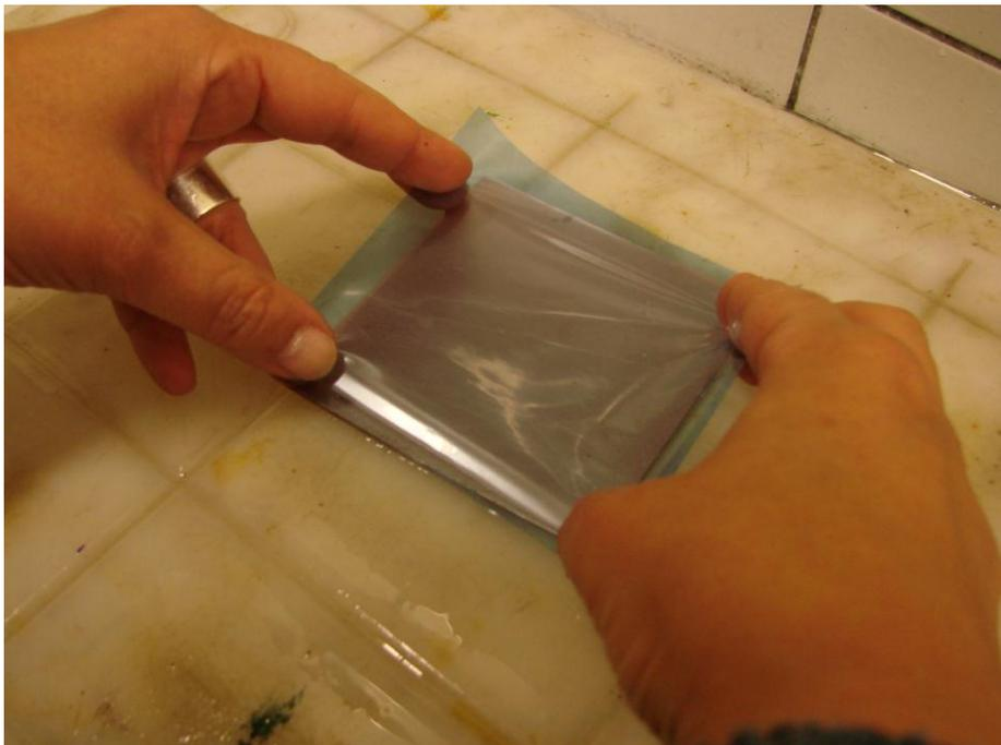
Fig. 11 e 12. Aplicação do filme fotopolímero na placa de metal
