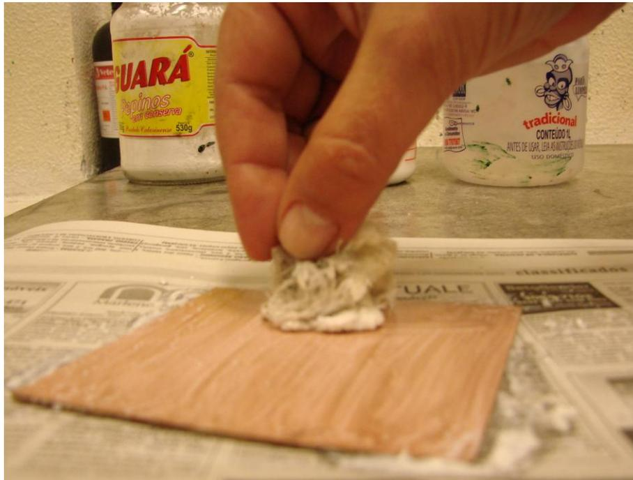
Fig. 09 e 10. Processo de desoxidação e limpeza da placa de metal
