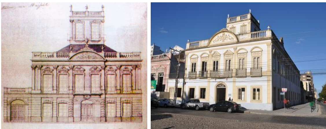
Figura 2: Na imagem à esquerda: Projeto de reforma da fachada do sobrado do Barão de Butuí, realizado pelo construtor italiano José Isella. Fonte: CHEVALLIER, Ceres. José Isella: arquitetura em Pelotas na segunda metade do século XIX. Pelotas: Mundial, 2002. p. 175. Na imagem à direita: O sobrado do Barão de Butuí. Fonte: Foto do autor, 2011.
