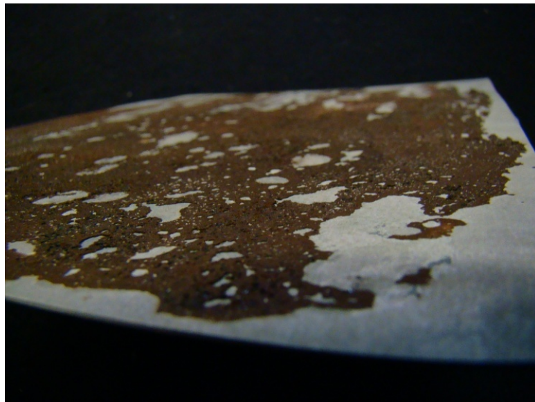
Figura 5 – Matriz de alumínio com o resíduo do cubo de ferro fixado sobre a superfície do metal.
