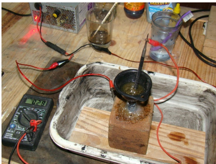
Figura 6: Extração do minério de ferro com o processo semi-seco (eletrólise)
