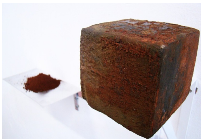
Figura 3 – Cubo de ferro e fragmentos da corrosão por eletrólise
