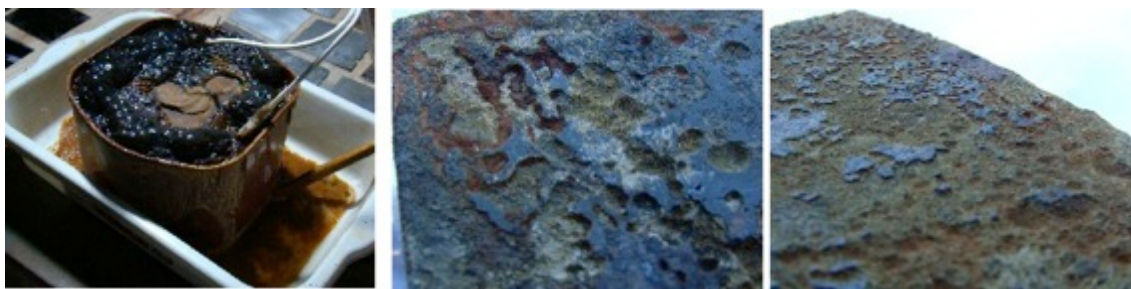
Figura 2: (a) Corrosão do cubo de ferro por eletrólise; (b, c) marcas na superfície do cubo
