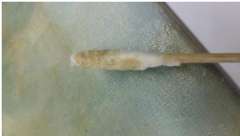
Figura 7: Teste de solubilidade do verniz com a mescla escolhida (2017). Fonte: Autoral.
